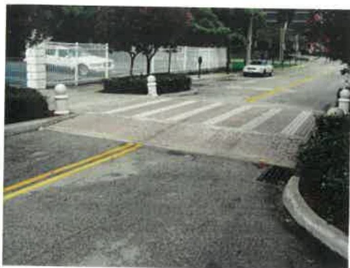
Figură 9-9 Exemplu de trecere pietonală înălțată
